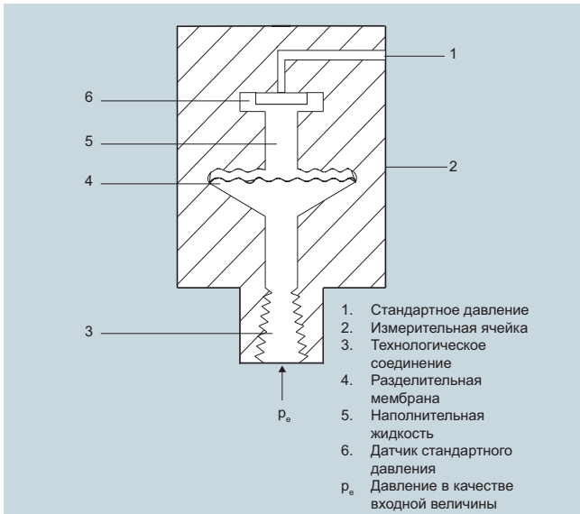
Измерительная ячейка для избыточного давления
